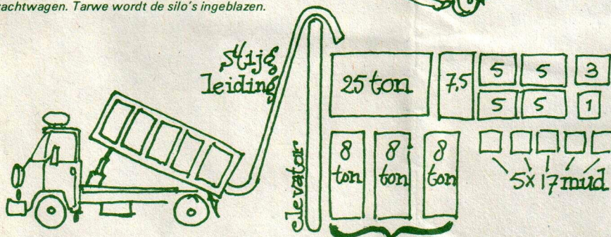
Deze 3x 8-tons-silo's staan in de schuur vlakbij de molen. Van daaruit de molen in met de eigen auto (gezakt of in bulk). (zie 2.)
